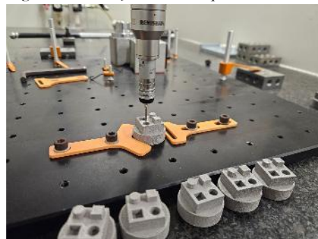
Figura 3 - Medição com máquina de coordenadas
