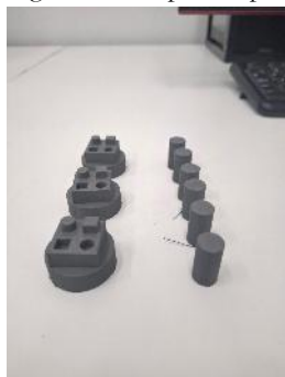
Figura 1 - Corpos de prova impressos
