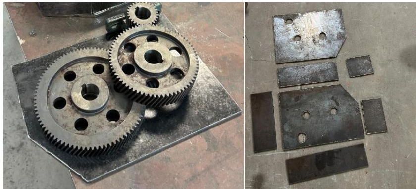
Figura 4 - Peças da caixa de transmissão construídas.
