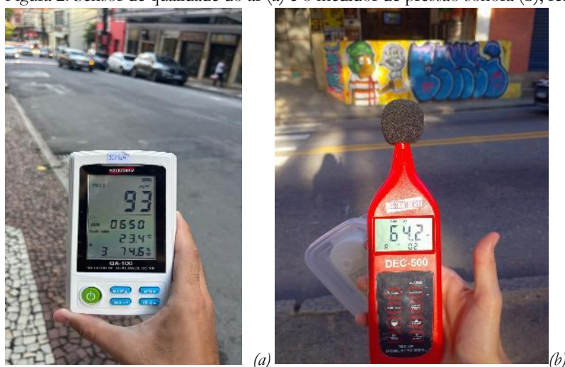
Figura 2. Sensor de qualidade do ar (a) e o medidor de pressão sonora (b), respectivamente.
