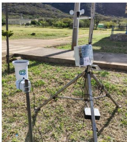
Figura 2. Estação meteorológica de baixo custo movida a energia solar e baterias. Fonte: Autor (2023)
