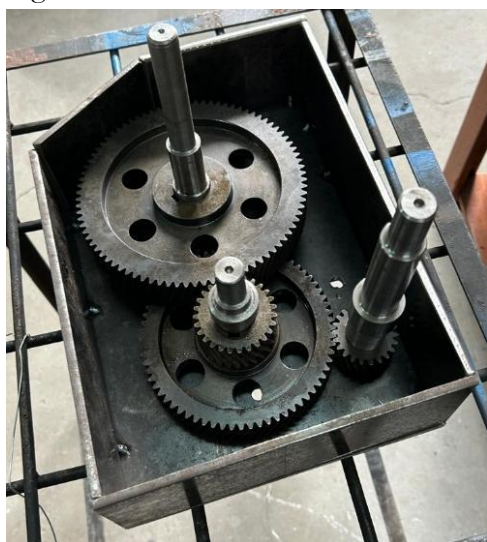
Figura 5 - Caixa de Transmissão montada
