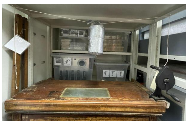
Fig. 3 - Fotografia do datalogger HOB0 dentro do abrigo envolto em papel alumínio, posicionado para fazer as medições. Foto: Bárbara Oliveira, 2025.
